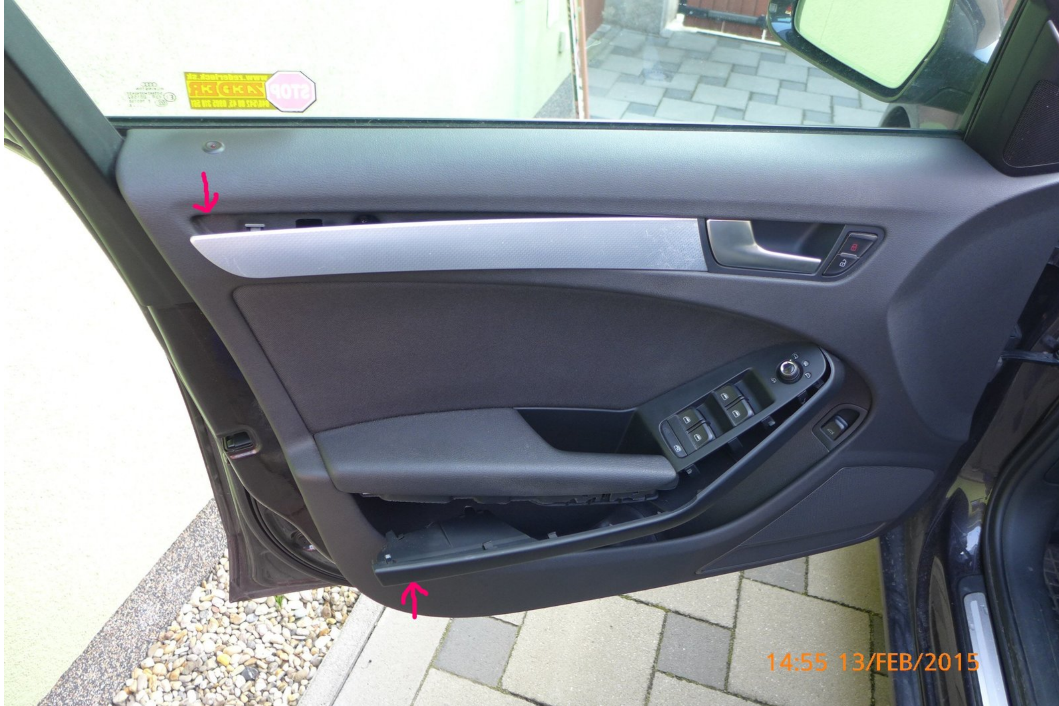
3, 5 Torx Schrauben entfernen.
