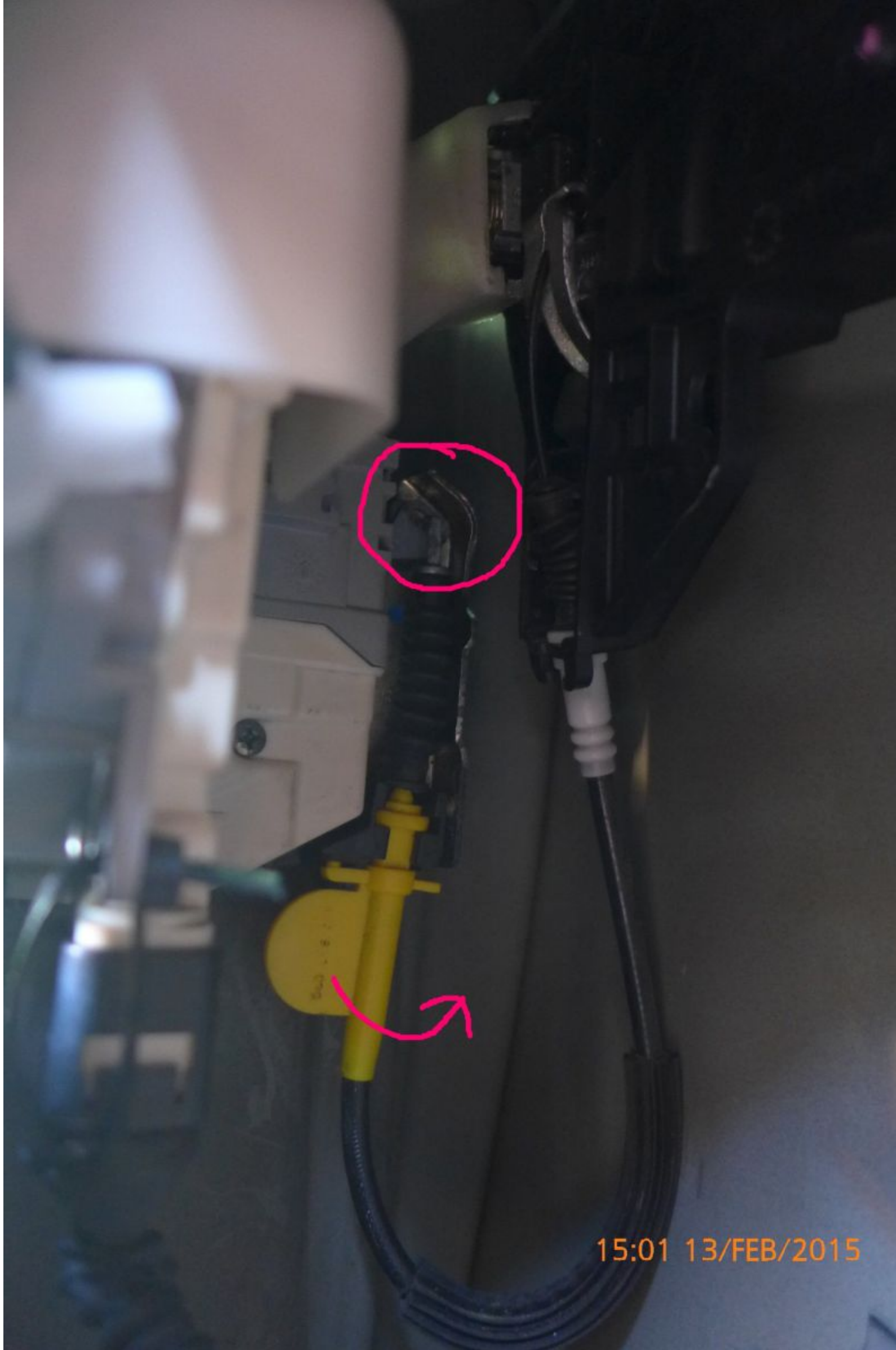
9, Schlosszylinder entfernen - Schraube unter Deckel mit Inbus komplett ausschrauben, reindrücken, dann Zylinder rausnehmen
