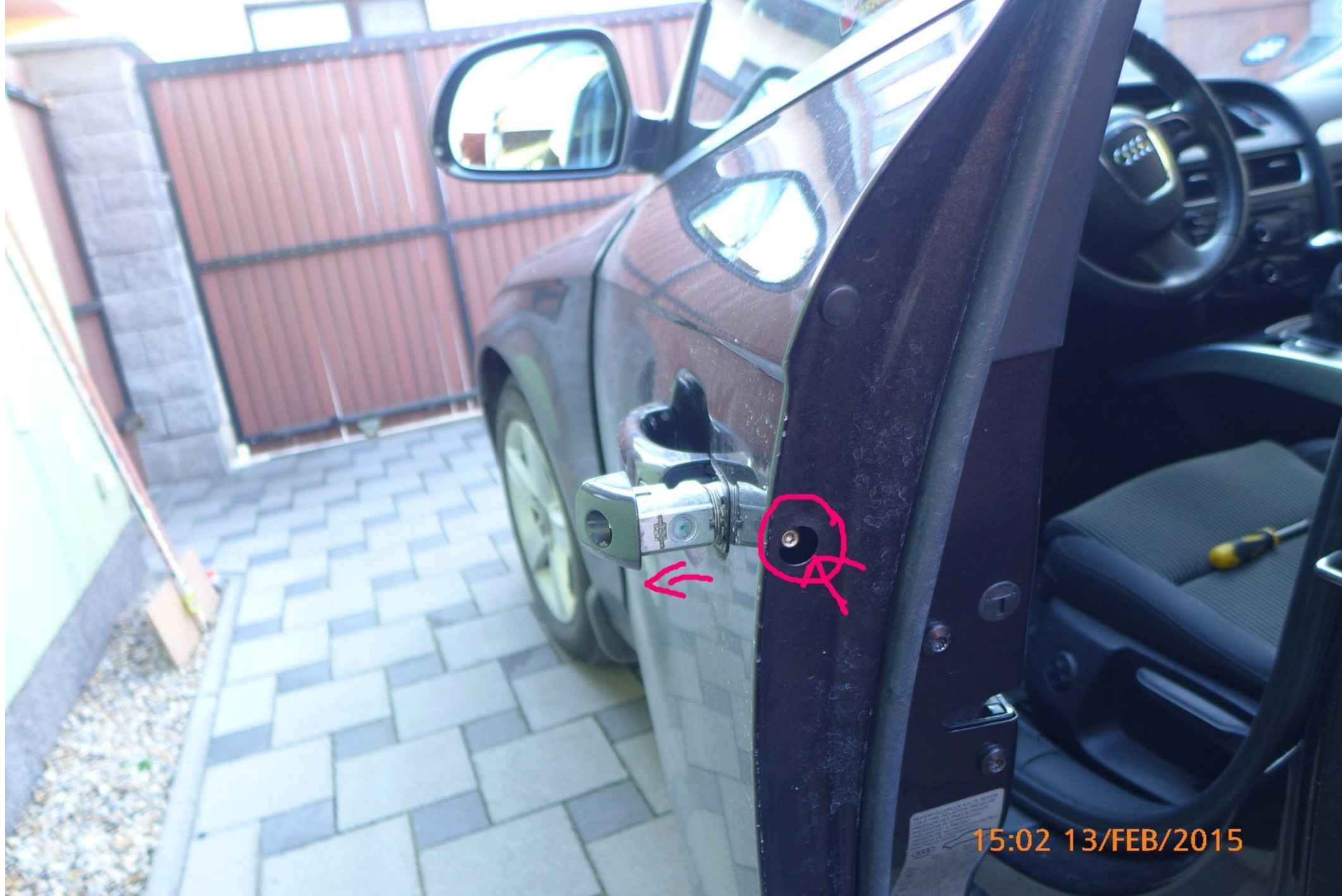
10, merken, wie es "drinnen" aussieht - der weisse Schlosdeckel kann man später falsch ansetzen - zu tief, auch zu hoch - dann geht der Zylinder nicht mehr wieder rein
