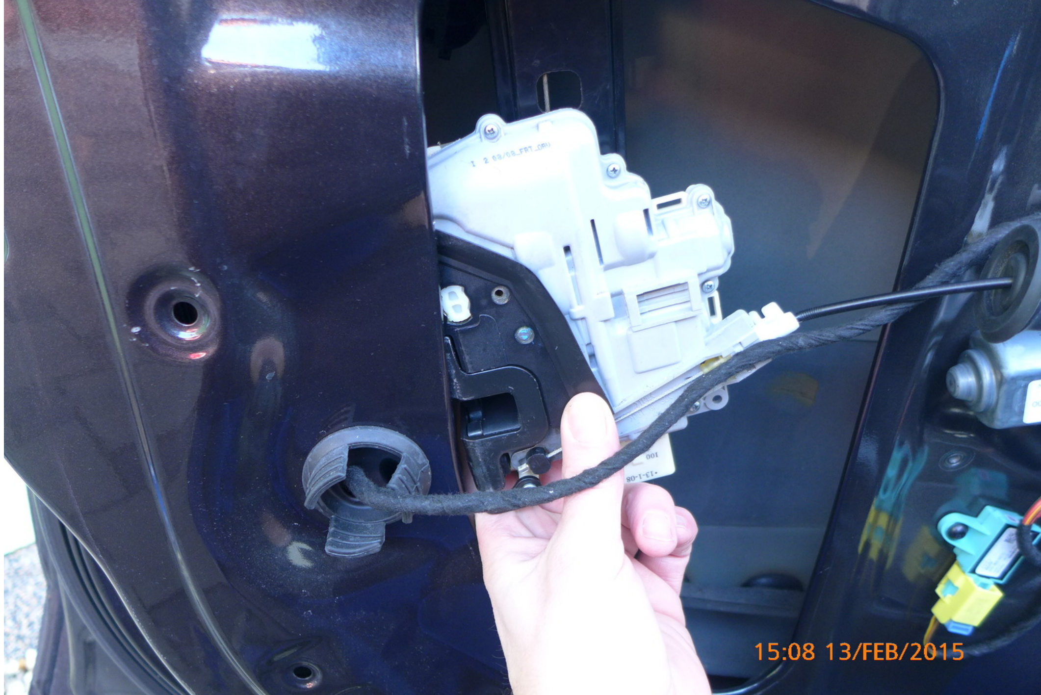
14, Schloss ist raus - Innerer Seilzug entfernen
