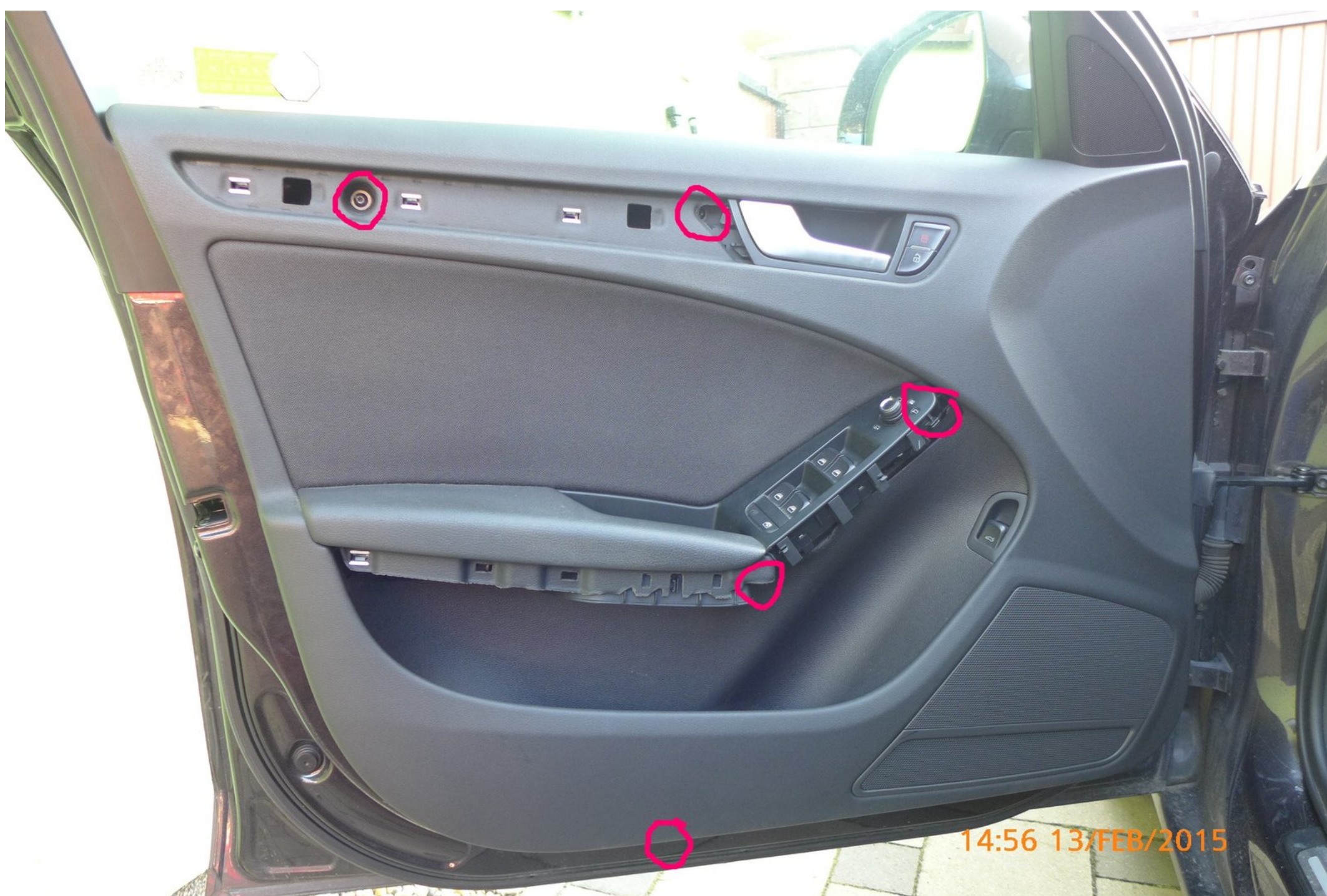
3, 5 Torx Schrauben entfernen.
