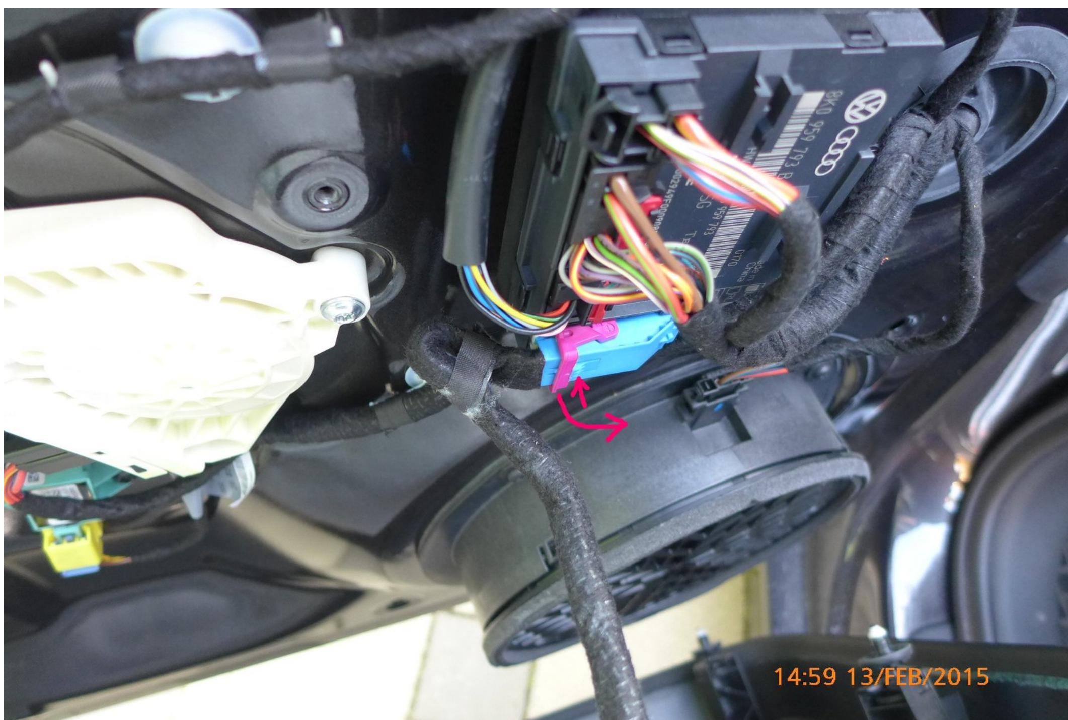
5: Stecker vom Türsteuergerät lösen
