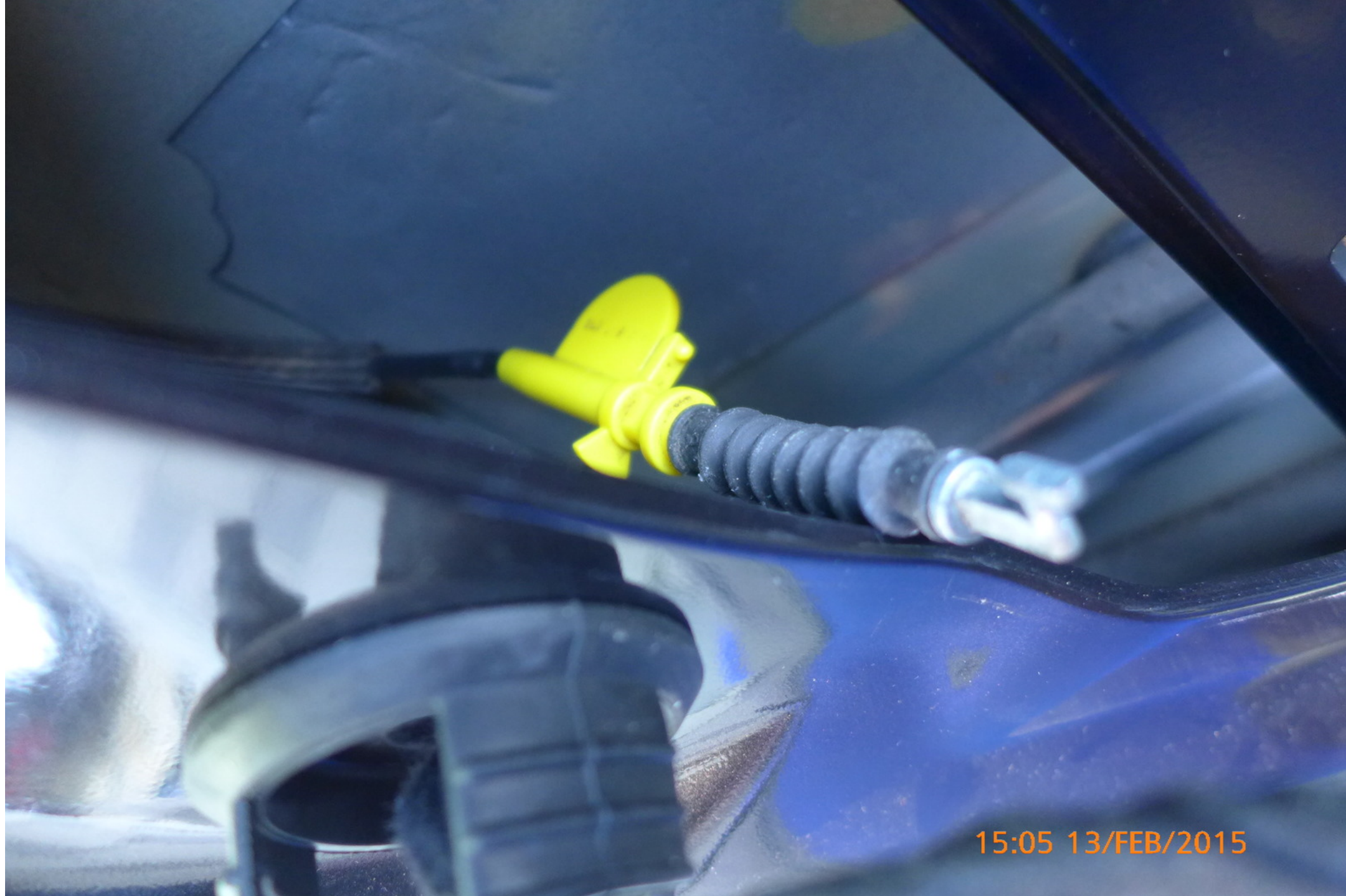
12, Schloss mit Deckel. Deckel entfernen - noch in der Tür - Einrastung drücken und rausschieben. Elektrostecker entfernen. Deckel zuerst aus der Tür rausnehmen.
