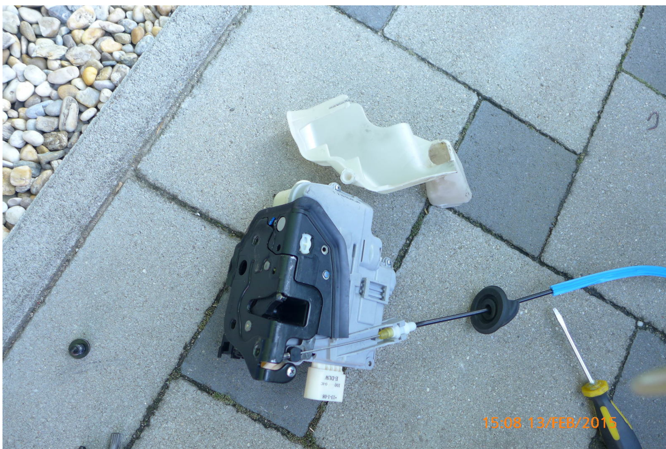
15, 4 Grössere Kreuzschrauben rausschrauben. Mechanik ist vor Elektronik "fast" gelöst. Es haltet nur eine Nase an gelbem Stift.
