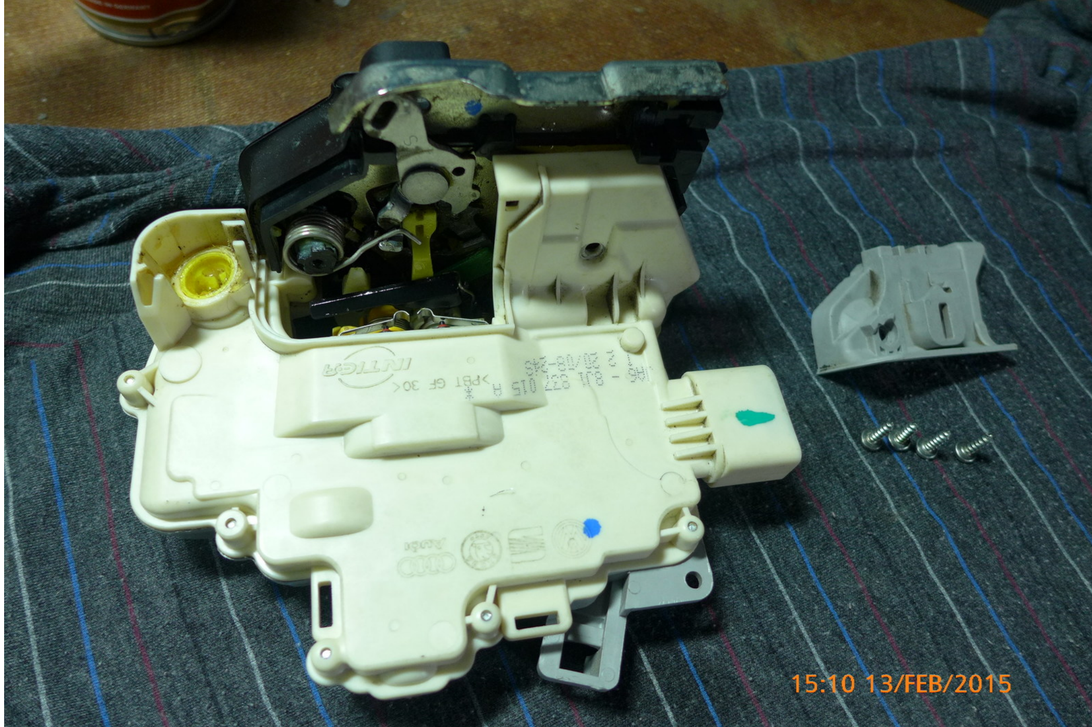
16, grüne Plastik muss man über die Nase des gelben Stifts raushebeln nach oben - mit Hilfe eines flachen Schraubenziehers, wo Pfeil ist - ansetzen.
