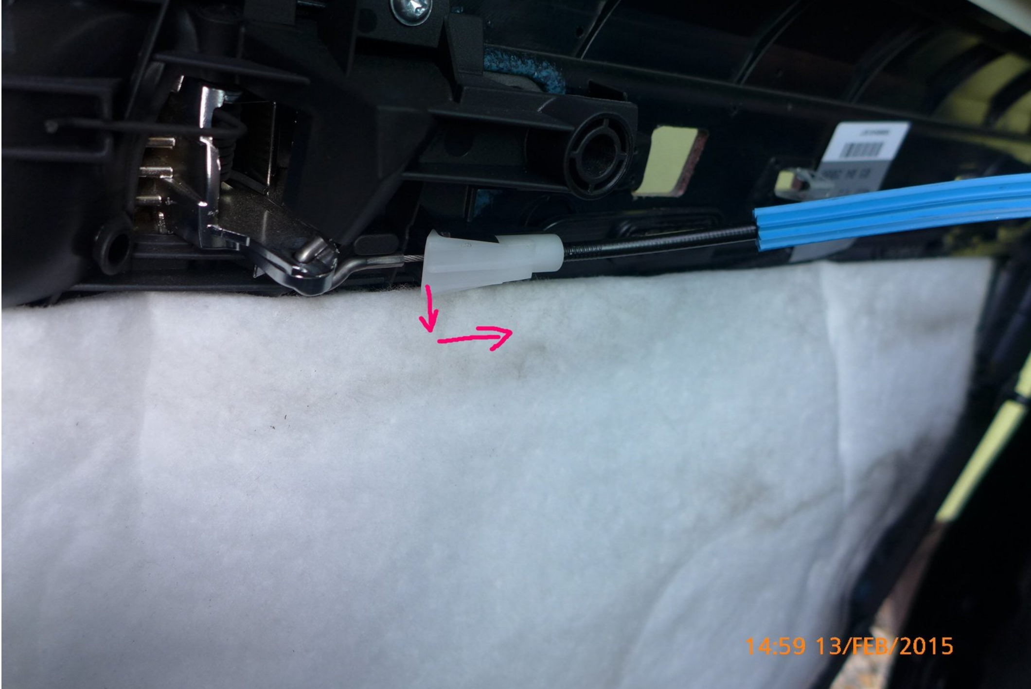
7, Deckel entfernen, dabei Kabel aushängen und die Tülle reindrücken. Turquis ist ein Airbagauslöser-wird später erklärt-der belassen.
